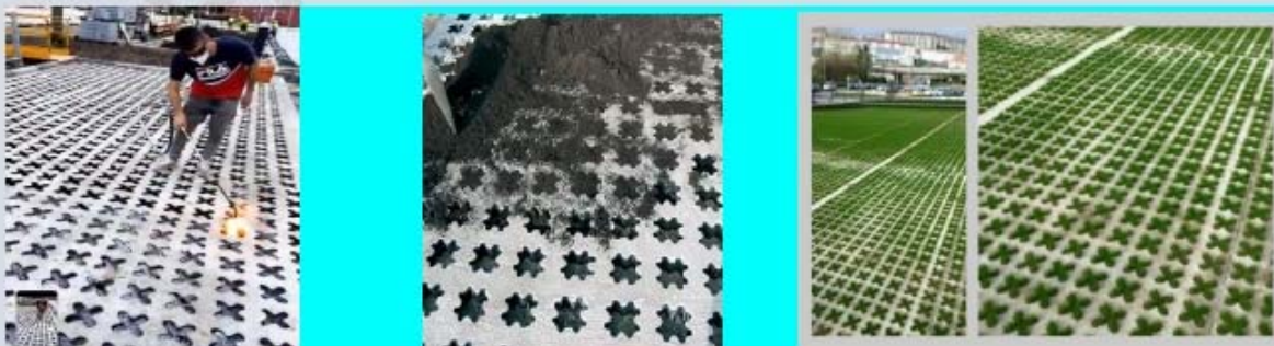
ROTURA Y QUEMADO DE LA PARTE SUPERIOR Y PAREDES DEL MOLDE
