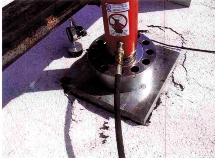
Particolare del sistema di carico e modalità di rottura del campione.
