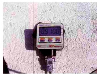
Particolare dell'elemento collassato in mezzeria e della lettura del carico massimo.
