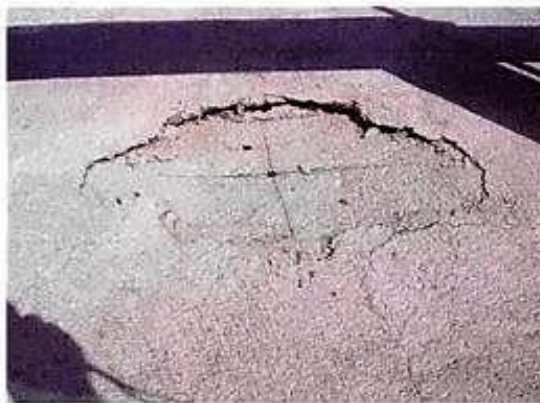
Particolare dell'elemento collassato in mezzeria e della lettura del carico massimo.
